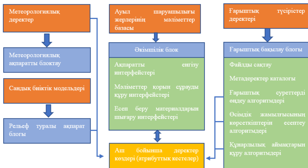
2-сурет – Ауыл шаруашылығы алқаптарының ғарыштық мониторингі геосервисінің функционалдық құрылымы
