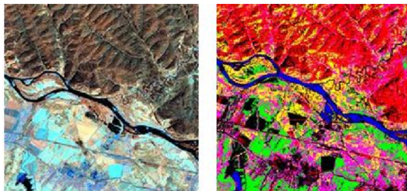
6 – сурет «Landsat» бастапқы суреті және спектрлік бұрыш әдісімен жасалған классификация нәтижесі
